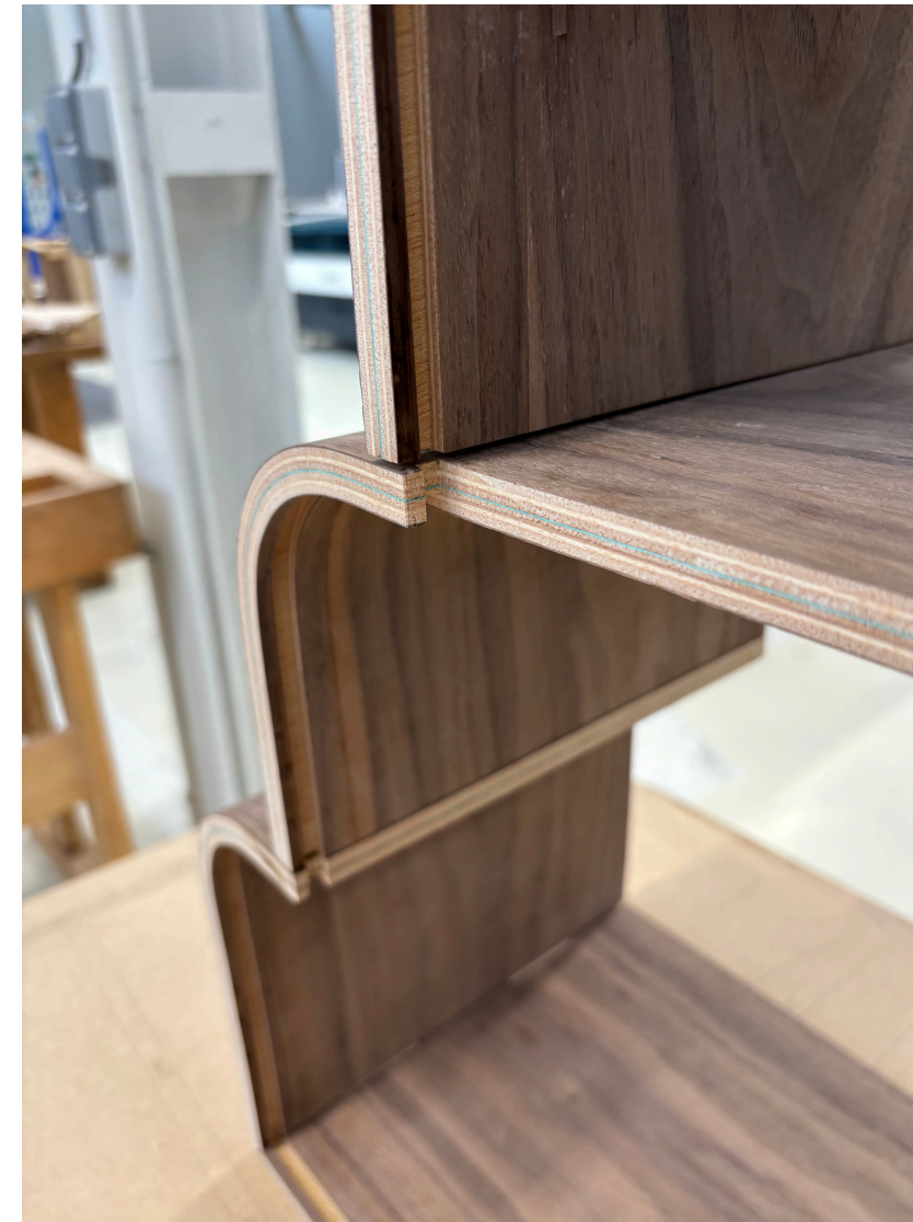
résultat de la rainure (fente permettant de venir imbriquer une pièce).
