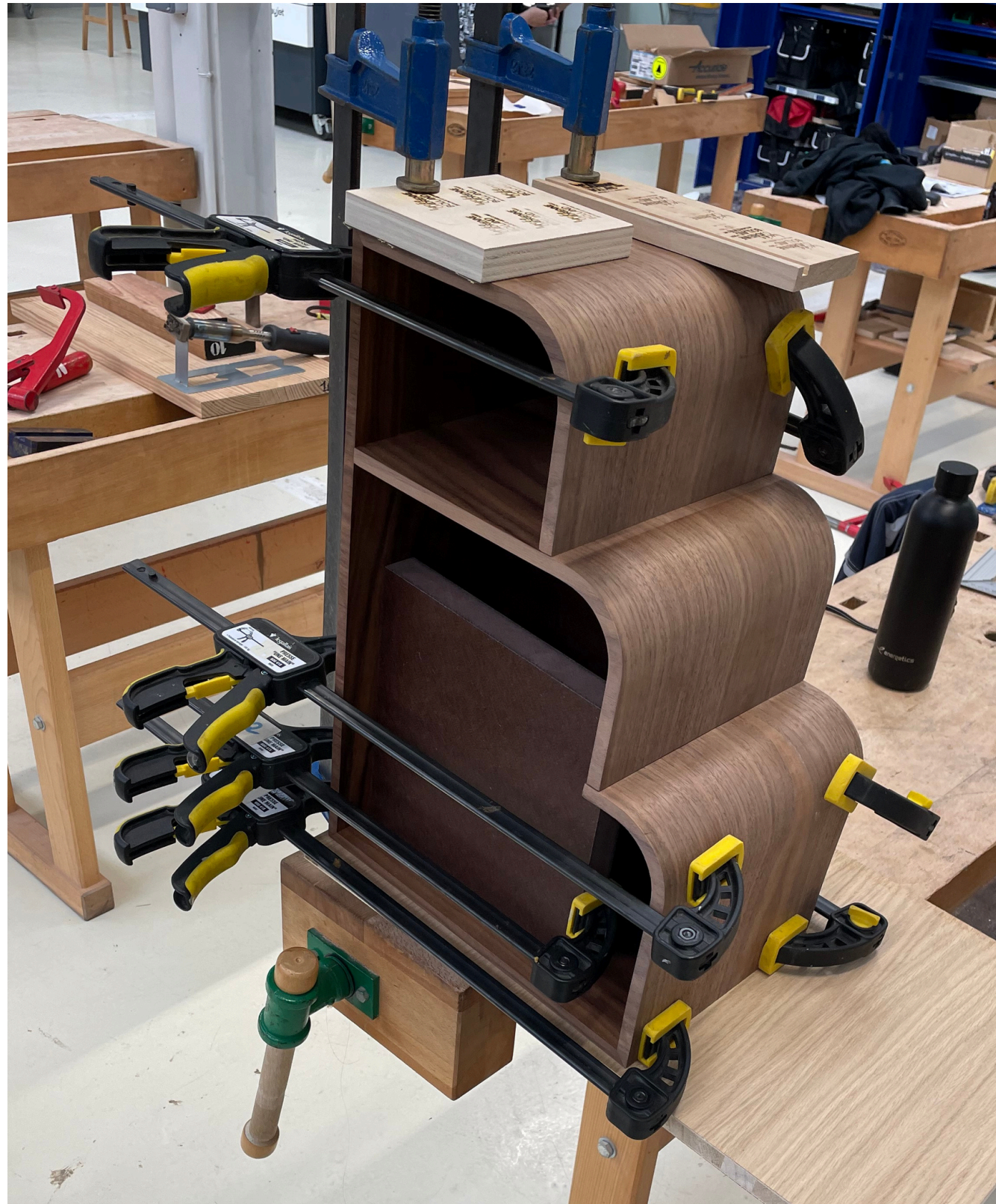
Mise en place du corps avec assemblage à lamello et colle blanche.
