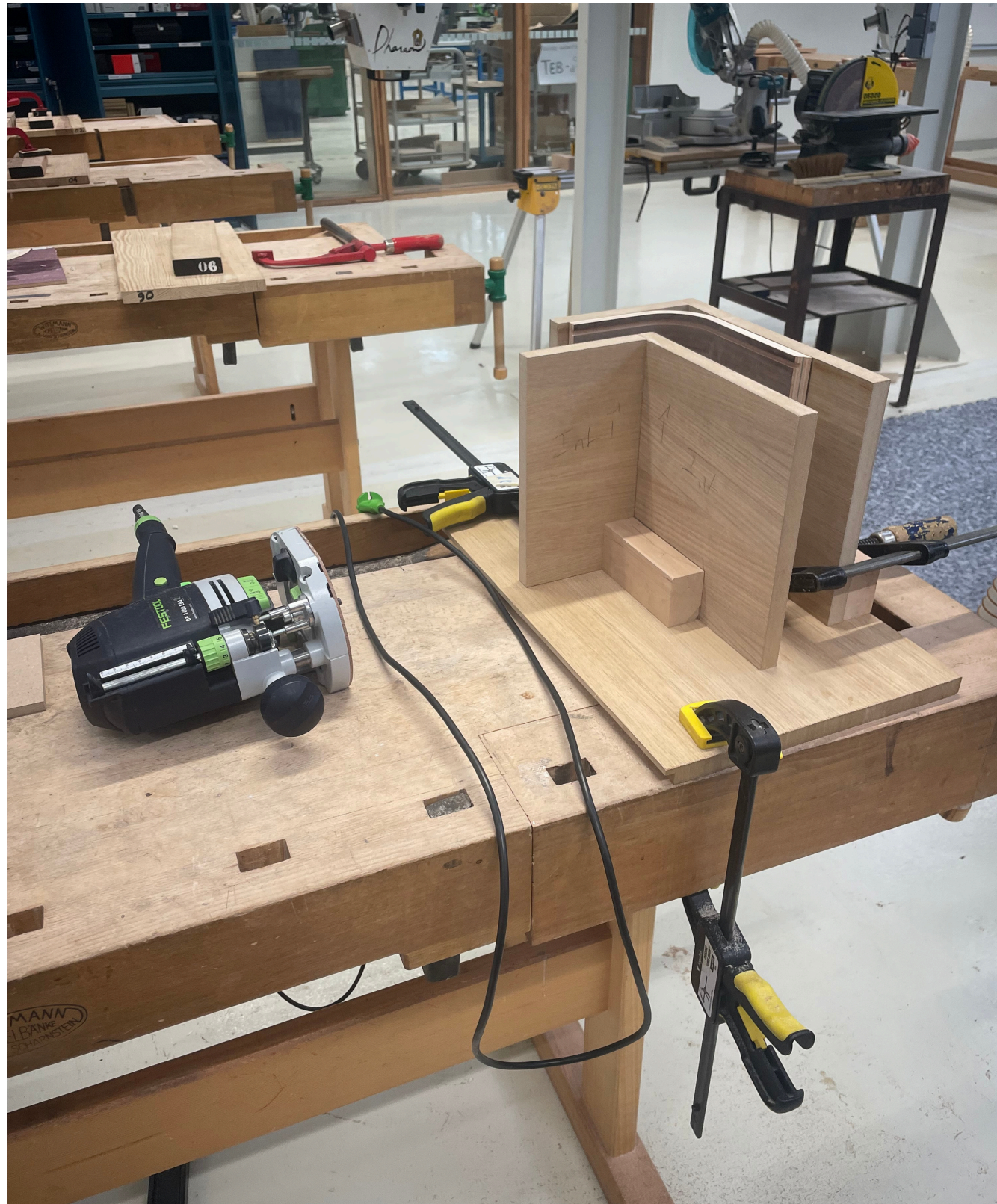
Montage d'usinage pour rainurer les côtés accueillant le fond. Rainurage à l'aide d'une défonceuse.
